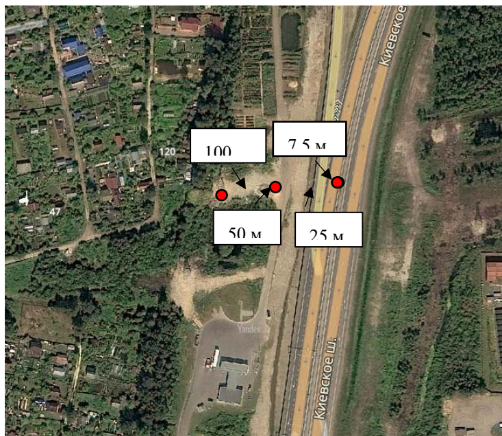
Рисунок 4 – Схема проведения измерений Киевское ш.
