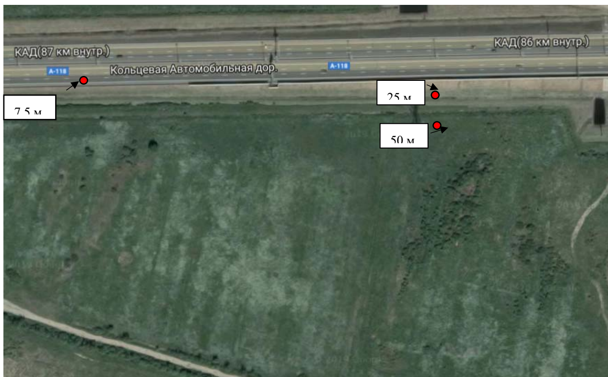
Рисунок 6 – Схема проведения измерений КАД (п. Новоселье)
